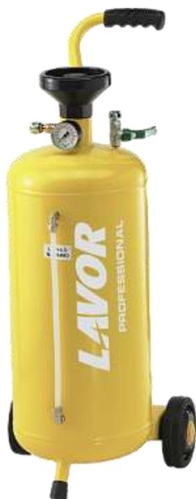
Пеногенератор Lavor (Лавор) Pro SPRAY NV 24 создает пену из раствора моющего средства, которую при помощи специальной насадки можно наносить на различные поверхности от автомобилей до стен промышленных помещений. Максимальное давление профессионального пеногенератора Lavor ProSPRAY NV 24 равно 6 бар. Манометр на корпусе устройства позволяет контролировать давление в режиме реального времени.
